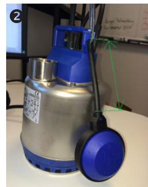
Vippans styrkabel skall vara 80 mm lång från pump till underkant flottör.
