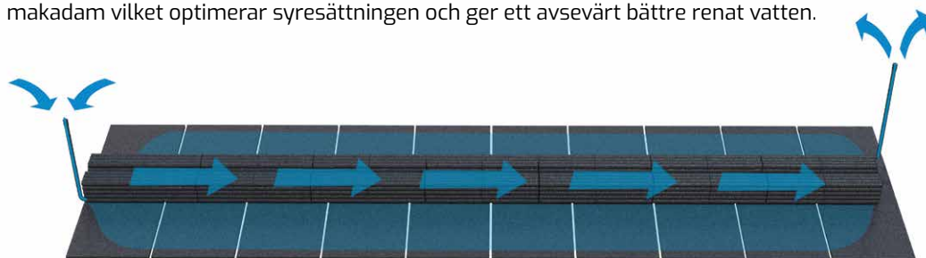
Bilden visar luftflödet i bioModuler och spridarplattor.
