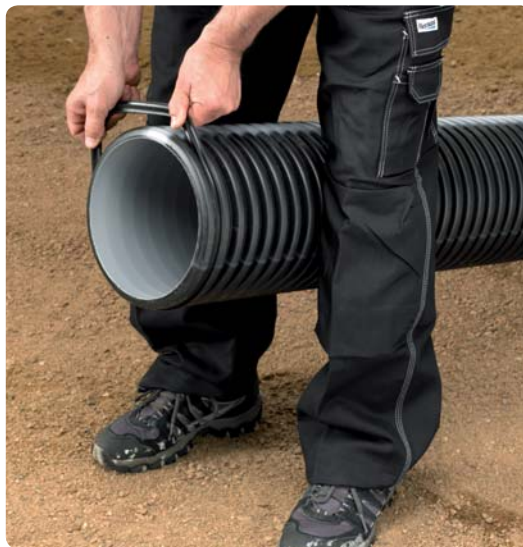
2. För tätt rörsystem monteras tätningsskivan som sätts i första spåret från spetsändan.
