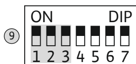
Fig. 19: DIP-brytare 2: Övervakning av driftparametrar
