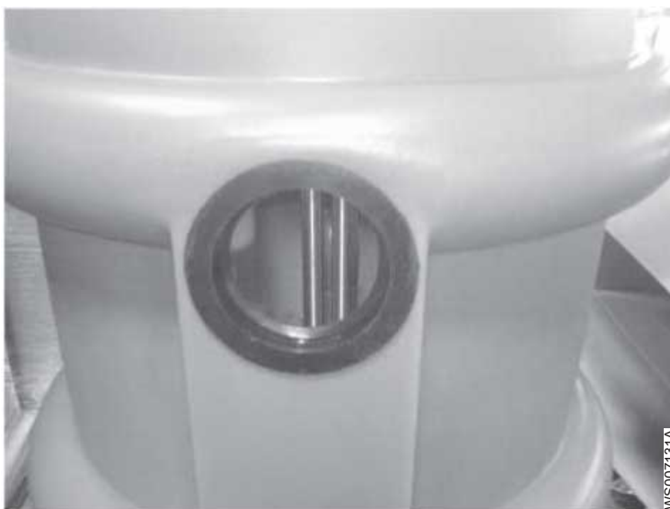
Figur 4: Inloppsrör diameter 100 mm
